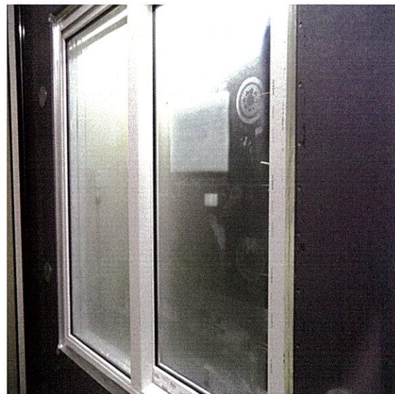
<사진 2> 열관류율 저온측 시험체 모습
