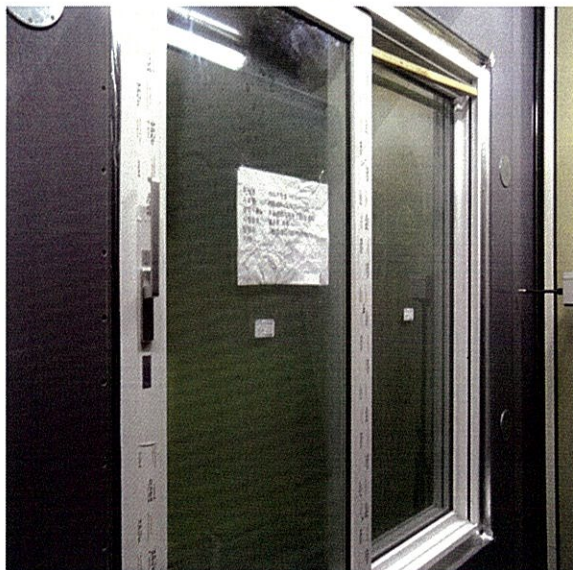
<사진 1> 열관류율 향온측 시험체 모습
